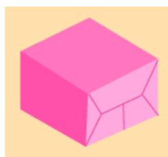
キャラメル包装は、包み紙と箱を正対させてイラストのように仕上げる包み方です。今回導入した自動処理機は1時間当たり約1,500個のキャラメル包装能力を有しています。人手に換算すると約30人分に相当します。1箱当たりの制限重量は約8キログラム。糊づけは、機械が糊を薄く噴霧する構造のため、貼り付け部分の凹凸が少なく、綺麗な包装に仕上がります。
